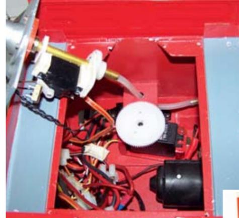
Das Servo mit Zahnrad für den Drehantrieb am Löschmonitor
