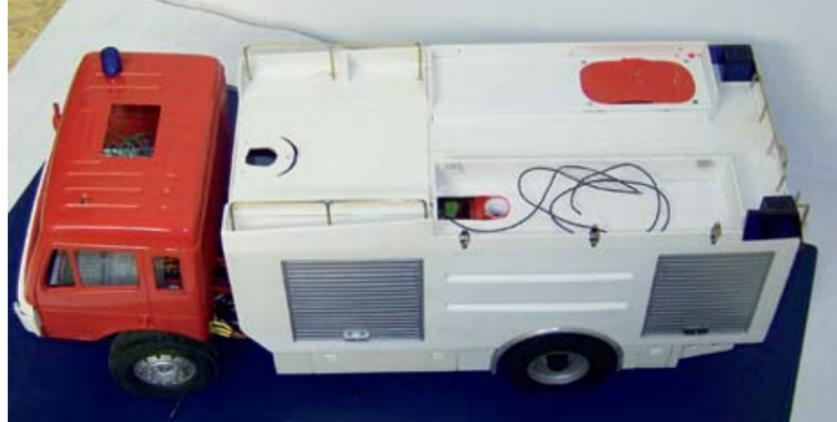
Vogelperspektive: rechts oben die Lautsprecherabdeckung, links die Einfüllöffnung des Tanks
