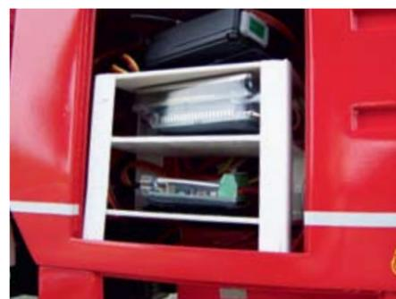
Die Elektronikkomponenten sind herausnehmbar hinter den Rollläden platziert
