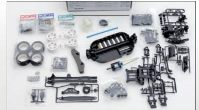
Inhalt des Bausatzes, der zwar auch über Motor und Räder verfügt, aber nicht über die Fernsteuerkomponenten und die Karosserie
