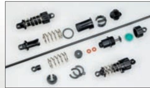
Der Vergleich des R-Chassis-Stoßdämpfers (unten) mit dem Stoßdämpfer des Standard-TT-01 unterstreicht die Wertigkeit des R-Chassis
