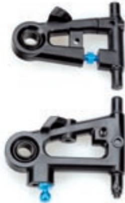
Die vorderen oberen Dreieckslenker haben in einem Schenkel eine Rechts-Links-Gewindestrebe, im anderen Schenkel ermöglicht ein Stift die Verkürzung beziehungsweise Verlängerung des Schenkels
