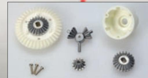
Diese Differentialgetriebe-Konstruktion mit drei Kegelrädern bewährt sich schon seit vielen Jahren in Tamiya-Modellen
