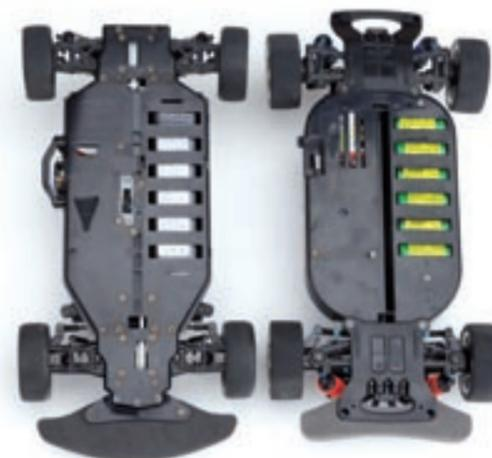
Beide Chassis schützen die Technik durch eine Bodenwanne, die beim TA-05 trotz des Riementriebs schmaler ausfällt
