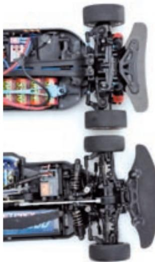
Klassische Federbeinposition des TT-01R (oben) gegen innovative liegende Stoßdämpferanordnung beim TA-05 (unten)
