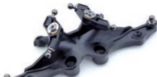
Die Umlenkhebel für die liegenden Stoßdämpfer sind auf einer massiven Kunststoffbrücke arrangiert
