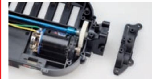
Das Getriebe ist durch eine Kapselung geschützt
