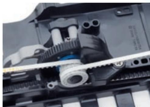
Mittig sitzendes Getriebe mit zwei gleichlangen Riemen zur Vorder- und Hinterachse
