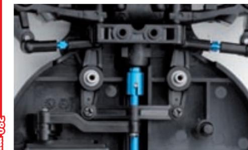
Komplett in Kunststoff ausgeführter Lenkmechanismus, jedoch mit Kugellager- und L-/R-Gewindeausstattung
