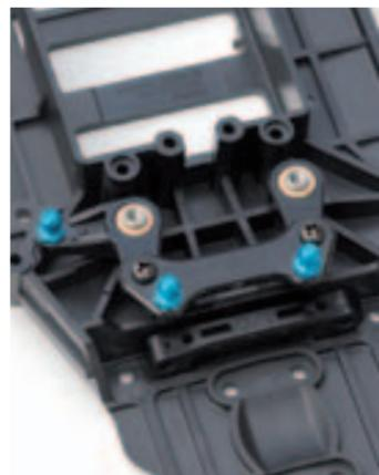
Der Zusammenbau beginnt mit dem Einbau der Lenkbrücke
