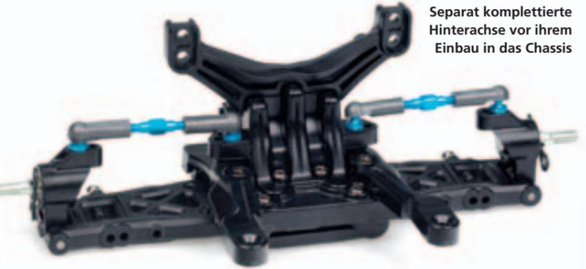
Separat komplettierte Hinterachse vor ihrem Einbau in das Chassis
