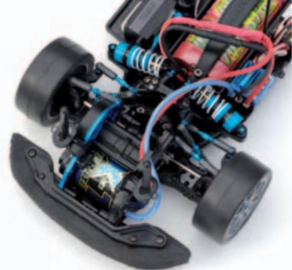
Das Ausführen der Motorkabel ohne Steckverbindung schafft zusätzlich Platz und minimiert die elektrischen Verluste
