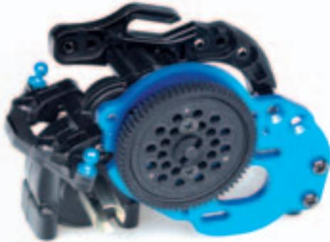
Für eine solide Verbindung von Getriebe und Motor sorgen eine massive Aluminiumplatte mit Kühlfunktion sowie ein zusätzlicher Bügel auf der Gegenseite
