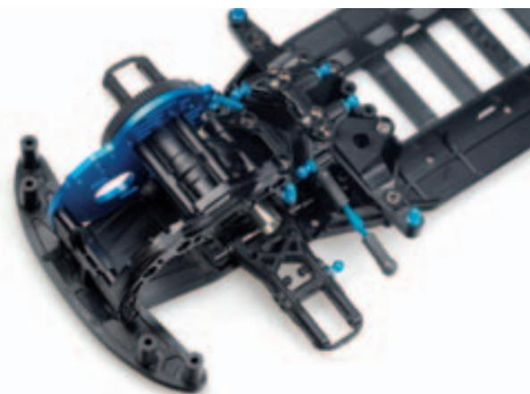
Der Motor liegt deutlich vor der Vorderachse und sitzt zwischen Aluminiumplatte und dem gegenüberliegenden Bügel in einem schützenden Käfig
